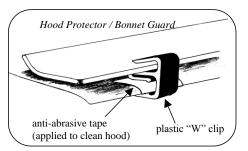
CLOSE THE HOOD BY DROPPING FROM 6" HEIGHT. ASSIST CLOSURE ONLY BY PRESSING ON THE <u>HOOD</u>. NEVER PRESS ON THE HOOD PROTECTOR.
